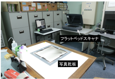
写真乾板スキャンシステム ： 写真乾板のスキャンシステムの全体像を示す。このシステムにより写真乾板一枚の測定は凡そ10分程を要した。
