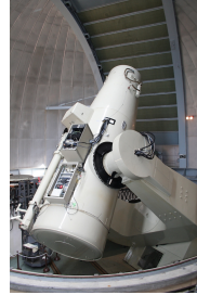
105cmシュミット望遠鏡 ： 長野県木曾郡木曾町に1974年に設置された。口径：1050mm 焦点距離：3300mm
